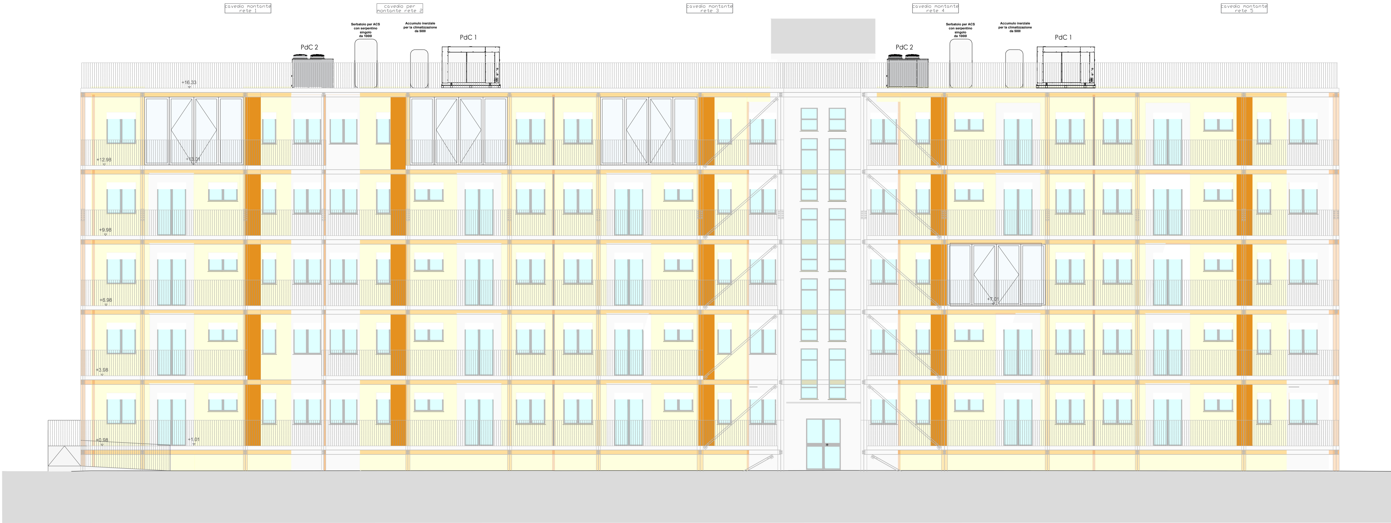
Montanti verticali e cavedio della rete idronica - Prospetto Ovest Edificio A
